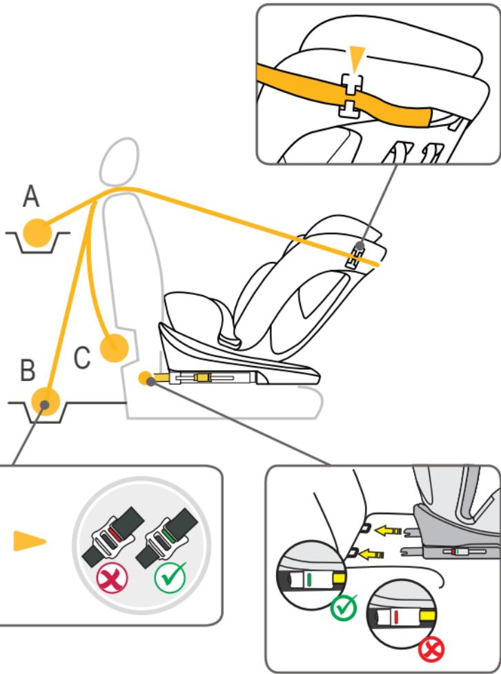
1. Réglez le siège-auto sur la position allongée maximale 3 et faites-le pivoter de manière à ce qu'il soit orienté vers l'arrière en position assise R.
