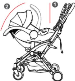
1. Um die Babyschale anzubringen, platzieren Sie die Babyschale auf den Adaptern, so dass diese rechts und links in die Einfassung passen. Der Tragegriff muss in der vordersten Position (1) sein. Drücken Sie die Babyschale leicht nach unten, so dass die Babyschale richtig auf den Adaptern sitzt.
