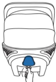
1. Lösen Sie die Verriegelung der Klappe, indem Sie die Lasche nach unten drücken.
