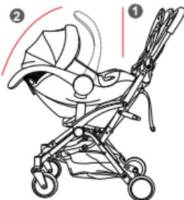
1. Pour mettre en place la coque bébé, placez-la sur les adaptateurs de sorte qu'elle rentre à gauche et à droite dans le châssis. La poignée doit être sur la position la plus en avant (1). Appuyez légèrement la coque bébé vers le bas de sorte qu'elle soit bien fixée dans les adaptateurs.
