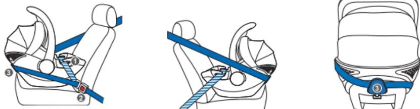
1. Ziehen Sie den Sicherheitsgurt des Fahrzeuges lang und führen den Beckengurt unter der seitlichen Führung (1) rechts und links durch.
